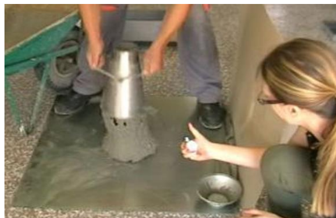
Sl. 2. Mjerenje konzistencije svježeg samougrađujućeg betona – dizanje Abramsovog konusa iz normalnog položaja
